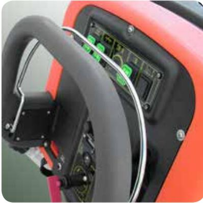
Panel de control analógico. Palanca de mando del cepillo y de distribución de la solución limpiadora. Interruptor de llave ON/OFF y para la exclusión de la batería, interruptor motor cepillos y de aspiración, sistema automático de dosificación de los productos químicos. Disyuntores térmicos para proteger los
