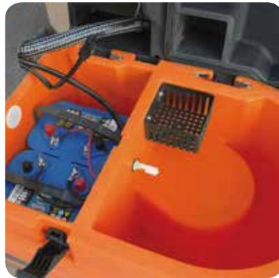
Depósito agua de recuperación con inspección visual. Extremadamente silencioso (62 dB) debido a la especial posición del motor de aspiración y el uso de materiales de aislamiento acústico.
